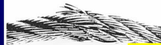
Cliché 6 - Roturas de alambres a la altura de la polea profunda sobre una pequeña longitud de cable El cable debe ser retirado
