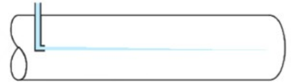
جریان لایه‌ای (Laminar Flow)
